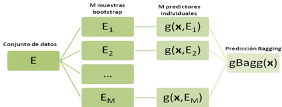
Figura 1: Esquema del algoritmo de clasificación Bagging
